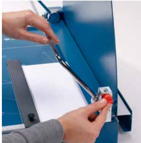
Docisk dźwigniowy zapewnia stabilizację ciętego materiału
